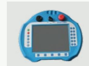
全闭环式控制保证机器运动精度及可靠性，教导式自由编辑程式操作便利，为多语种菜单式真彩触摸屏操作界面。
